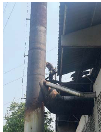
ภาพที่ 3.2.3-1 แสดงการตรวจวัดคุณภาพอากาศในปล่องเตาเผาขยะ
